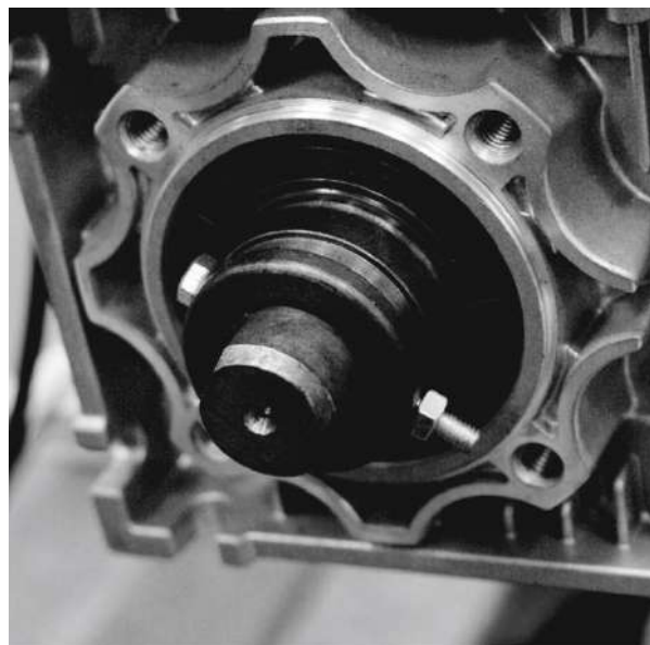
Krok 7. Prawidłowo założona śruba.
